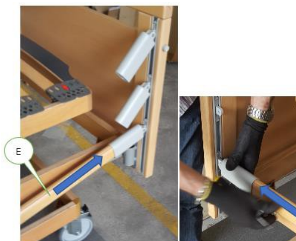
Figura 16 - Installazione Sponde - Inserimento Asta
