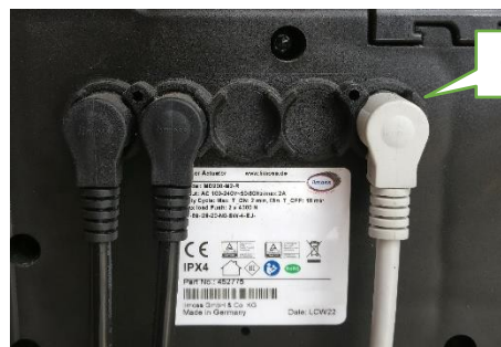
Figura 11 – Montaggio testiera/pediera - Connessione telecomando al motore
