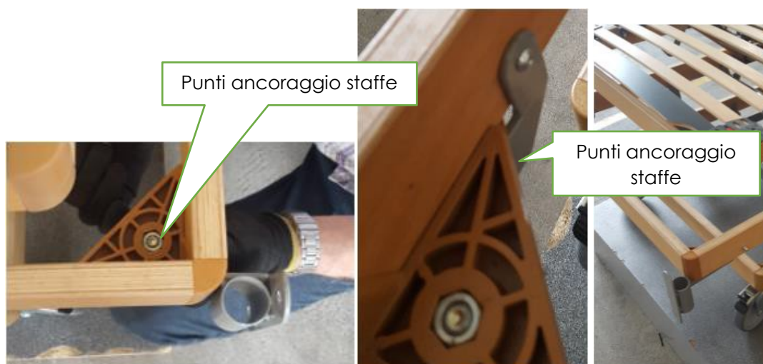
Figura 13 - Montaggio testiera/pediera – installazione staffe
