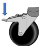
Figura 9 - Inserimento Freno Ruote
