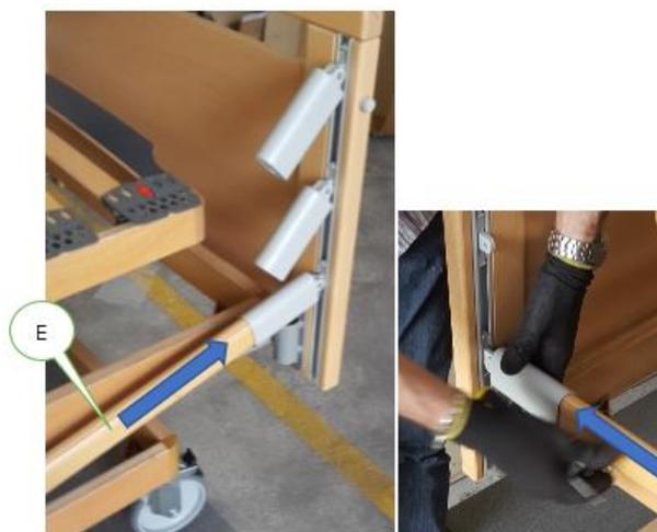
Figura 16 - Installazione Sponde - Inserimento Asta
