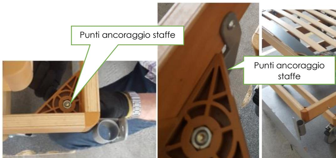
Figura 13 - Montaggio testiera/pediera – installazione staffe
