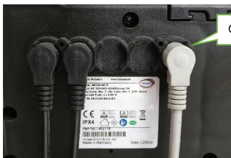
Figura 11 – Montaggio testiera/pediera - Connessione telecomando al motore
