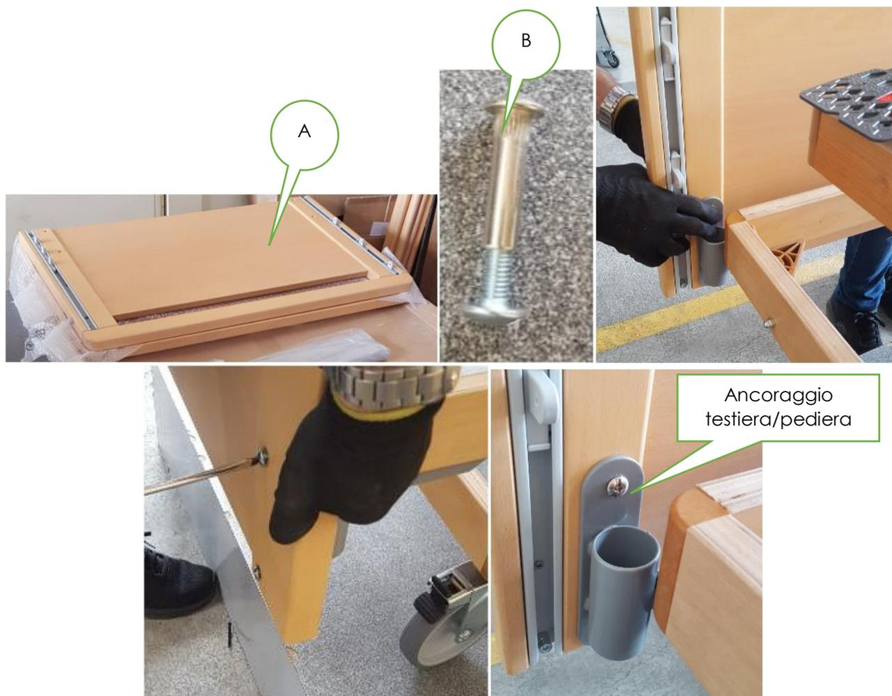
Figura 14 - installazione testiera e pediera
