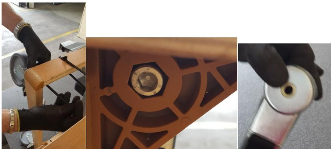
Figura 28 - Sostituzione Ruote
